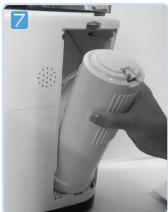
Пожалуйста, удалите защитную пленку на новом фильтре. Сначала вставьте нижнюю часть фильтра в гнездо, надавите, затем поверните его налево (ЗАКРЫТЬ / CLOSE)/
